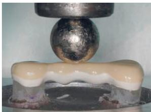
Versuchsaufbau mit standardisierten Probekörpern von der Universität Regensburg<sup>e)</sup>
