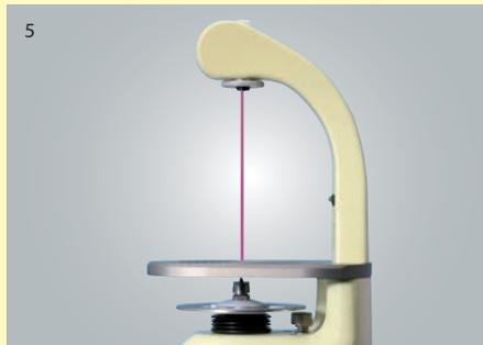
Exakter, im 90°-Winkel zum Bohrer montierter Modelltisch gewährleistet nachfolgend eine einfache Entnahme des Zahnkranzes vom Modellsockel.
