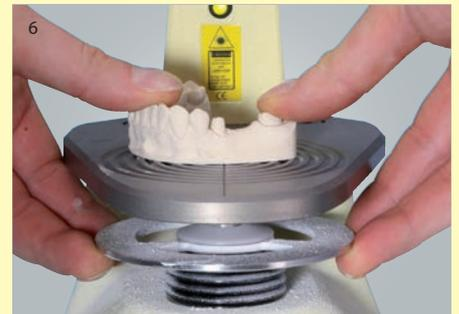
Der feste Halt des Zahnkranzes ermöglicht präzise Pinlochbohrung. Der Bohrer wird erschütterungsfrei zum Zahnkranz geführt.
