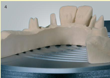
Eingearbeitete Schmutzrillen fangen den Gipsstaub auf und schaffen die Voraussetzung für einen parallel aufliegenden Zahnkranz.
