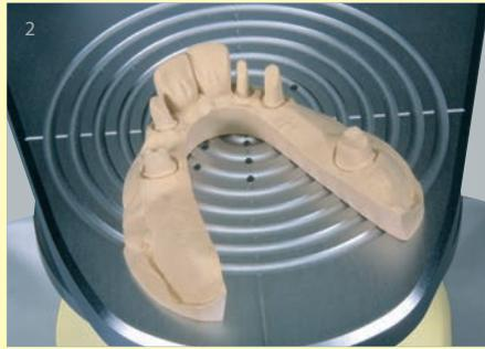
Fest montierter Modelltisch in der Form und Breite einem Zahnkranz angepasst.
