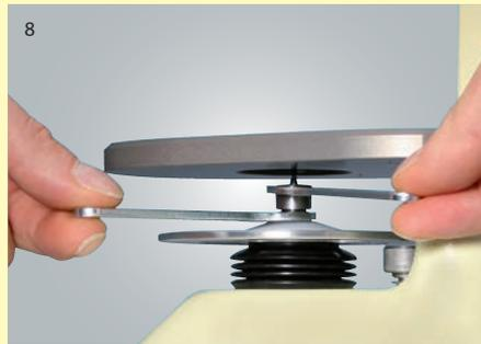
Ein Bohrerwechsel erfolgt von außen, ohne das Gerät öffnen zu müssen.
