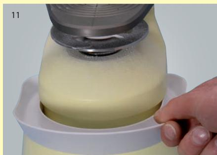
Gerät, Motor und Spannzange bleiben sauber; die Auffangschale ist abnehmbar.
