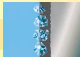
Diamantkristalle in einer galvanisierten Metallbindung.
