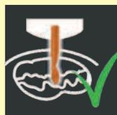
Grazie a una geometria di taglio speciale è possibile fresare senza raffreddamento ad acqua anche i materiali termoplastici, che hanno la caratteristica di impastarsi rapidamente, mettendo a dura prova lo strumento.
