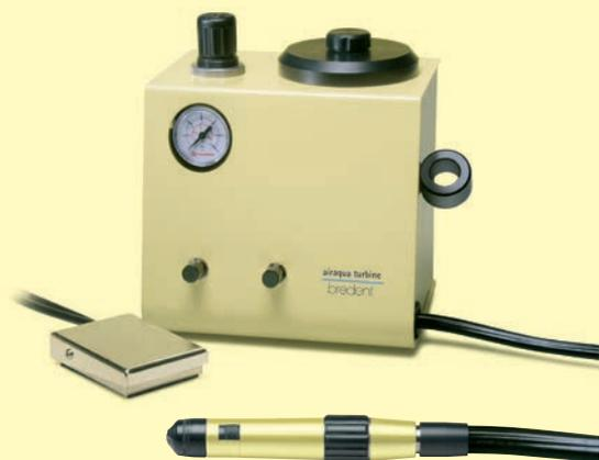
La turbina airaqua è un apparecchio compatto e maneggevole con un manipolo leggero che permette di lavorare con estrema precisione materiali duri, come ad esempio le ceramiche pressofuse, lo zirconio sinterizzato, e le vetroceramiche.
