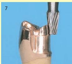
7 La spalla occlusale viene fresata con la fresa F205 3H 27.
