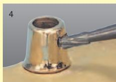
4 Le foret pointeau permet de déterminer le point exact de forage.
