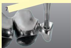
Fraiser le pas de vis dans la partie primaire avec le taraud ébaucheur puis avec le taraud à finir.
