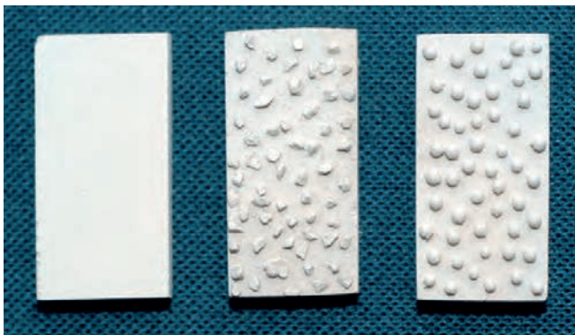
Abb. 7: Prüfkörper mit unterschiedlich vorbereiteten Oberflächen von BioHPP® (links: geschliffen, Mitte: Splitter, rechts: Perlen). 9)
