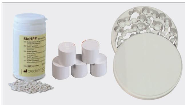
Fig. 18: BioHPP en las 3 diferentes formas de presentación: granulado, pellet y blank.<sup>23)</sup>
