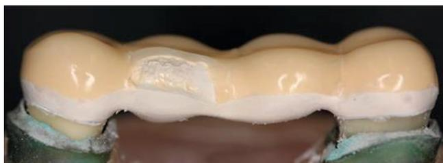
Fig. 39: Puente tras la prueba de carga con revestimiento desconchado.<sup>52)</sup>
