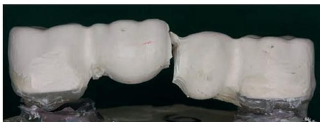
Fig. 33: Fractura de un puente de BioHPP fabricado con CAD/CAM.<sup>43)</sup>
