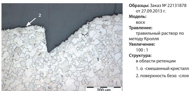
Рис. 28: Снимок структуры титана, сделанный при помощи оптического микроскопа, после термической нагрузки 630 °C.<sup>37)</sup>
