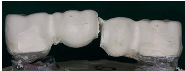
Рис. 33: Фактура моста, изготовленного из BioHPP посредством системы CAD/CAM.<sup>43)</sup>
