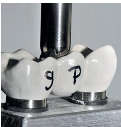
Рис. 19: Мост из BioHPP в процессе проверки.<sup>24)</sup>
