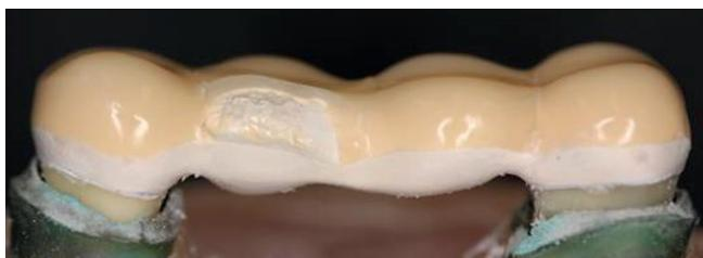
Рис. 39: Мост с отколотой облицовкой после испытания под нагрузкой.<sup>52)</sup>
