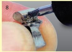
Mit dem Vorschneider wird die Basis für das Gewinde gelegt. Der Fertigschneider erzeugt ein hochpräzises Gewinde. Fräs- und Bohrröll verhindert das Festsetzen des Gewindeschneiders.
