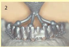
2 Auch kleinste Spannungen im kostengünstig und biokompatibel hergestellten Einstückguss werden bis zur Perfektion ausgeglichen.
