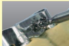
Durch die Körnung ist der Diatit-Multidrill 1,5 mm Durchmesser sicher fixiert.
