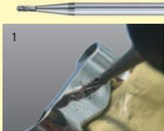
1 Mit dem Körnerbohrer wird die Position des Riegels bestimmt und eine kleine Mulde angelegt.
