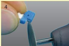
Das Keramikformteil mit einer Trennscheibe so beschleifen, dass es genau in den Verschluss des Riegelankers passt und ...
