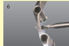
Mit dem Diatit-Multidril 1,4 und Fräs- und Bohröl wird ein Loch in der gewünschten Verschraubungsrichtung gebohrt.
