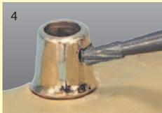
4 Der lagerichtige Bohrpunkt wird mit dem Körnerbohrer festgelegt.
