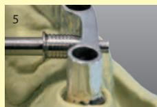
Die angussfähige Steckriegelhülse wird auf den Modellierstift A aufgesteckt und in das Riegelloch der Patrizie bis zum Anschlag gesteckt.
