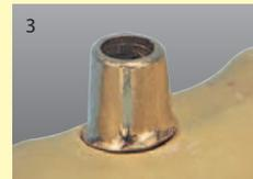
3 Nach dem Gießen erfolgt die Fräsung und Politur der Mesostruktur.
