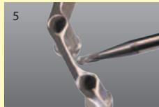
Mit dem HM-Körnerbohrer 1,4 wird an der entsprechenden Stelle eine Mulde gebohrt.
