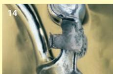
14 Der Steckriegel wird am Modellgussgerüst mit Kunststoff befestigt.
