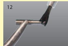
Die Stiftschraube wird nach der Isolierung in die Gewindehülse eingedreht.
