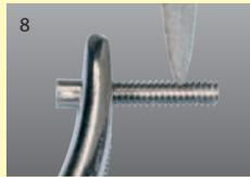
8 ...und Splintschraube werden bei Bedarf auf gleiche Länge gekürzt.
