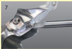
Die Riegelachse entsprechend der Situation kürzen. Eine Öffnerhilfe anbringen und die Riegelachse mit der Bolzenschraube fixieren.
