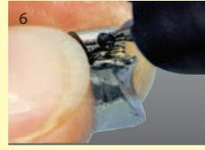
Mit dem Multidrillbohrer (1,2 x 5) aus dem Werkzeugsatz wird ca. 2 mm tief eingebohrt. Großzügiger Gebrauch von Fräs- und Bohrröll verhindert die Überhitzung des Bohrers.
