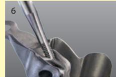
Nach dem Guss mit den Gewindeschneidern und viel Fräs- und Bohröl das Gewinde anfertigen.
