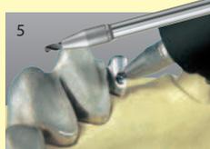
5 Sekundärteil entfernen und mit dem Diatit-Multidrill mit Anschlag in das Primärteil bis zum Anschlag bohren.
