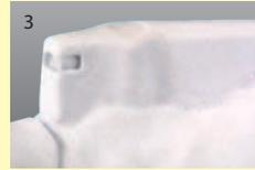
Auf dem Einbettmassmodell ist der Riegelanker gut sichtbar. Das Keramikformteil kann sicher im Verschluss platziert werden.
