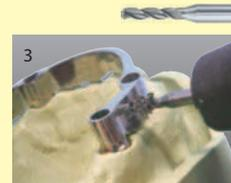
Der Steg wird mit dem Diatit-Multidrill und viel Fräs- und Bohröl durchgebohrt.
