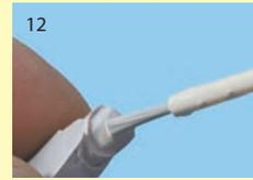
12 Die zur Hälfte in die Hülse eingeschraubte Splintschraube wird mit der Pinzette im Splintloch positioniert...
