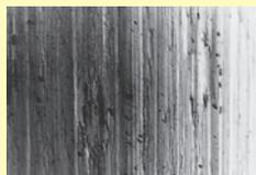
Rasterelektronenmikroskop-Aufnahme der Innenseite eines Teleskopsekundärteils aus einer EM-Legierung bei 100-facher Vergrößerung.
