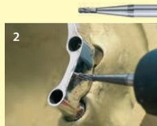
Mit dem Körnerbohrer wird die Position des Riegels bestimmt und eine kleine Mulde angelegt.
