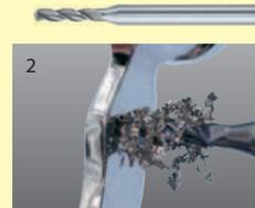
Mit dem Diatit-Multidill 1,5 mm Durchmesser wird das Loch für den Riegel gebohrt.
