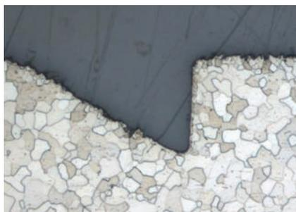
Teilkristallines BioHPP® und Titanoberfläche Oberfläche alpha – Case frei, Vergrößerung 100:1
