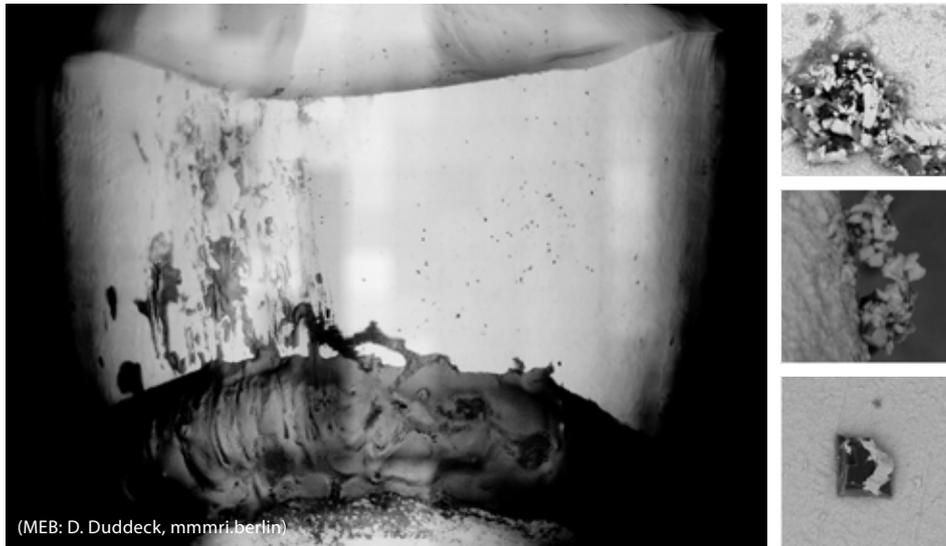
Imágenes obtenidas con el microscopio electrónico de barrido de la zona submucosa de un aditamento híbrido.
