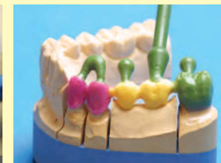
Colado mediante centrifugado
