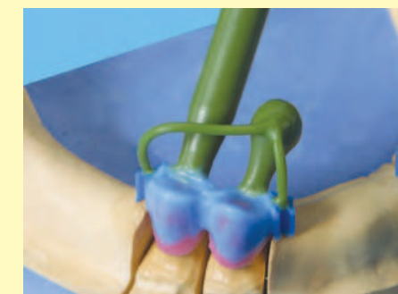
Colado con compresión al vacío
