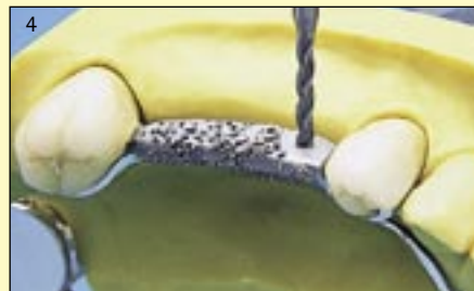
4 L'elevata stabilità e l'ottima potenza del motore assicurano perforazioni facili e precise anche su leghe per scheletrati, estremamente dure.
