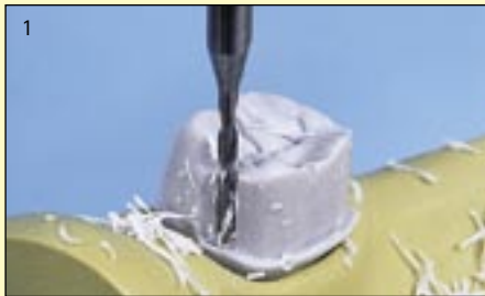
1 Fresaggi ottimali su cera grazie al controllo elettronico del numero di giri.
