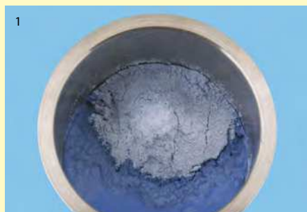
1 Цокольный гипс Флюид-Рок замешивают в соотношении 100 г порошка к 25 мл дистиллированной воды для получения жидкой консистенции.
