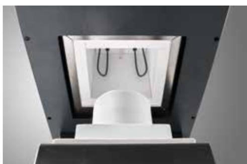
Gli elementi riscaldanti in disilicio di molibdene di alta qualità raggiungono una temperatura massima finale di 1.650°C.
