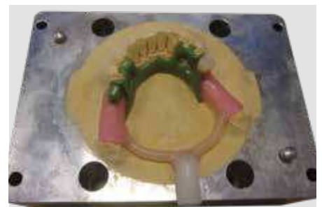
De manière alternative au positionnement de film de coulée on peut réaliser le positionnement de la sculpture avec deux canaux d'alimentation (Ø 5mm).
