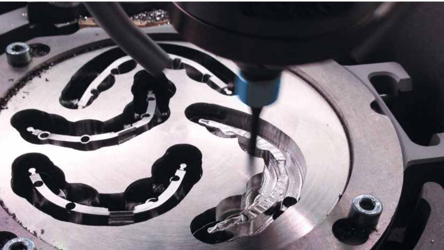
Le revêtement BLUE LINE améliore la résistance à l'usure et convainc par une très haute résistance à l'oxydation et une bonne dureté à chaud. Le très faible coefficient de frottement des outils réduit le dégagement de chaleur et les efforts de fraisage sur les arêtes de coupe. Des fraises plates pour l'usinage de piliers et barres ainsi que des outils de fraisage à grande vitesse pour le dégrossissage rapide sont disponibles.
