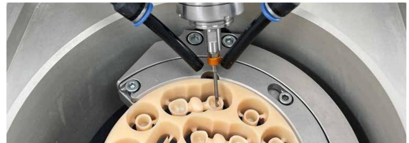
*L'utilisation des l'utilisation de longs outils nécessite une stratégie adéquate dans le logiciel FAO, en particulier pour les fraises à queue de 3 mm. DCS utilise également un logiciel FAO de qualité industrielle pour les systèmes DCX!*
