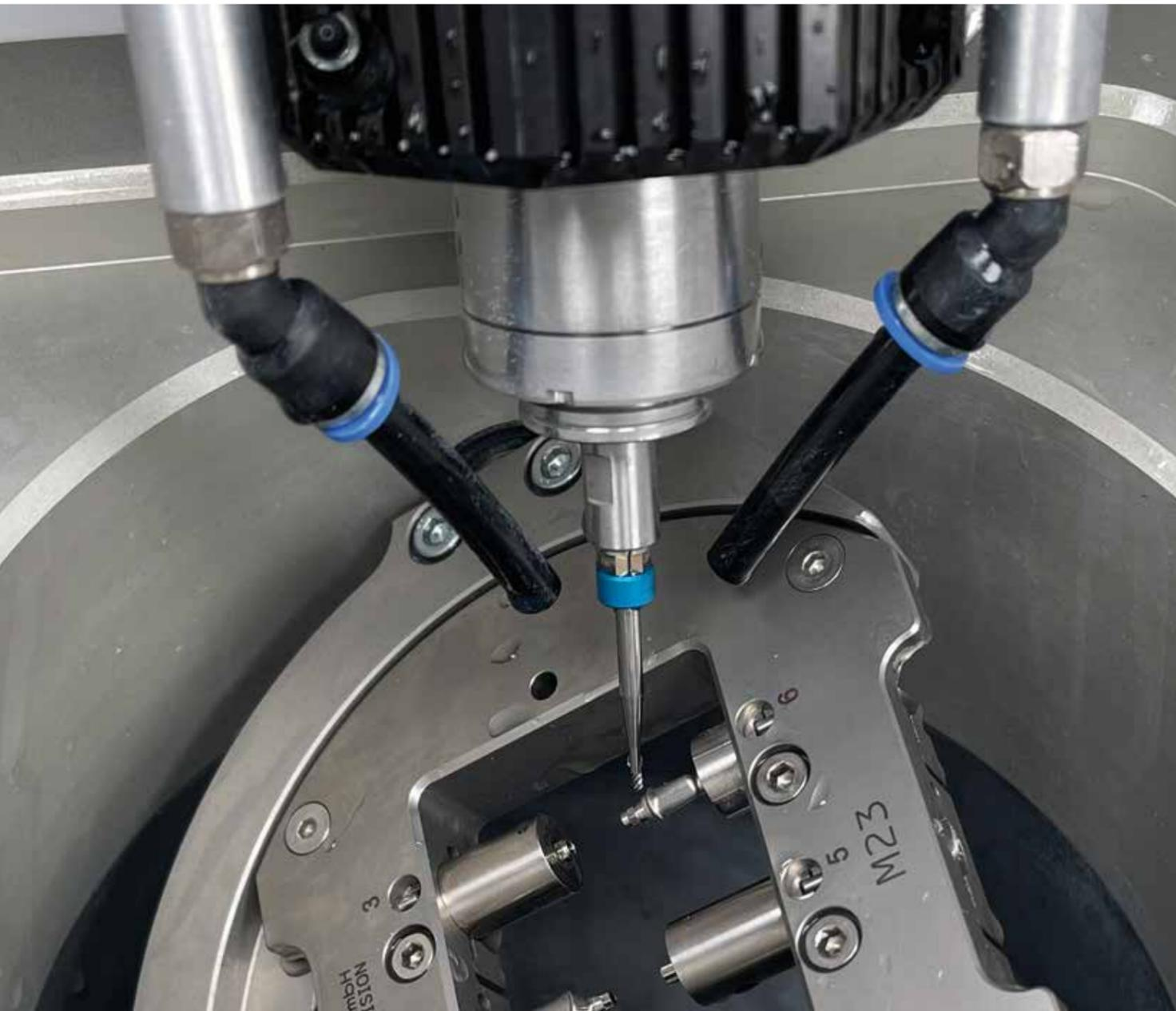
La fabrication de piliers en titane dans le procédé préfabriqué nécessite une précision particulière du système. Le système DCX dispose d'un étalonnage préfabriqué qui scanne chaque restauration et enregistre la position exacte des objets dans la commande. Le haut niveau de précision atteint par ce processus
