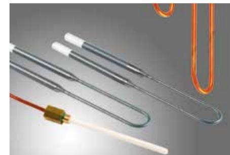
Hochwertige Heizelemente aus Molybdän Disilizid erreichen eine maximale Endtemperatur von 1650°C. Im Gegensatz zu Heizsystemen aus Siliziumcarbid sind Heizungen diesen Typs dabei ausreichend von ihrer höchsten Leistungsgrenze von ca.1800°C entfernt. Dank dieser Eigenschaft erreichen sie eine signifikant höhere Lebensdauer. Jedes der vier Heizelemente kann im Schadensfall einzeln ersetzt werden, ein Tausch „en bloc“ entfällt.
