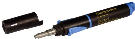
L'apparecchio Thermo-Pen è un soffiatore ad aria calda con sistema a piezo-elettrico, senza fiamma. Pertanto le faccette estetiche possono essere scaldate, senza il pericolo di essere bruciate. La temperatura necessaria per modellare le faccette è di ca. 250° C. Grazie alla dilatazione p.es. possono essere coperte in modo ottimale le corone telescopiche.
