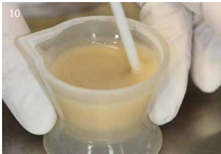
10 Mélanger homogènement top.lign professional avec un rapport de mélange de 10 g pour 7 ml & laisse gonfler 30 sec.
