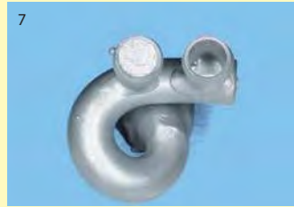
7 Die starke Expansion führte während der Verbrennungsphase bei dem Mitbewerber-Kunststoff zum Bruch des Einbettmassestumpfes in der Muffel. Die Krone ist nach dem Guss mit einem Deckel verschlossen und unbrauchbar. Ein Schnitt durch die gegossene Krone (Bild 8) zeigt den gebrochenen Stumpf.
