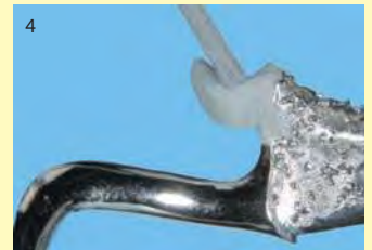
4 Die zu schützenden Stellen am Modellguss mit Oxyd-Stop macro einpinseln. Kurz antrocknen lassen.
