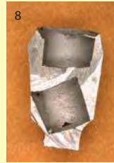
7 Die starke Expansion führte während der Verbrennungsphase bei dem Mitbewerber-Kunststoff zum Bruch des Einbettmassestumpfes in der Muffel. Die Krone ist nach dem Guss mit einem Deckel verschlossen und unbrauchbar. Ein Schnitt durch die gegossene Krone (Bild 8) zeigt den gebrochenen Stumpf.
