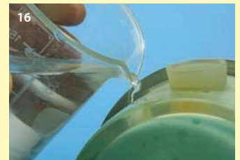
16 Mit kaltem Wasser wird eine Polymerisationsverzögerung erreicht. So kann Kunststoff während der Polymerisationsphase nachfließen.
