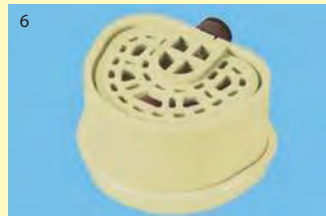
Der Dublierstabilisator wird in die Aufnahme der Küvettenmanschette gesteckt und die Höhe entsprechend dem Modell eingestellt. Dadurch wird die Silikonform beim Ausgießen mit Einbettmasse vor ungewolltem Verzug gesichert.
