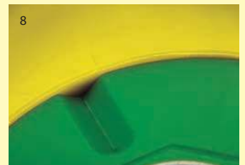
8 Die Platte ist dann richtig eingesetzt, wenn sich am Rand eine 0,1 mm hohe Stufe bildet.
