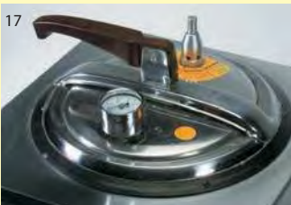
17 Im Drucktopf mit 2 bis 6 bar bei 40 bis 50 °C wird der Kunststoff 30 Minuten auspolymerisiert.
