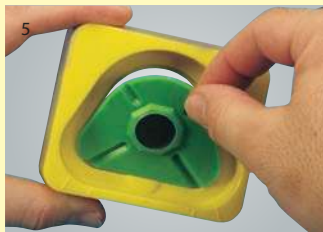
5 Das Einlegen des Master-Split Basisformers erfolgt zuerst am hinteren Rand.
