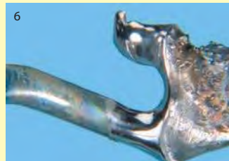
6 Mit Glanzstrahlperlen Oxyd-Stop macro entfernen und kurz überpolieren. Nur die ungeschützten Bereiche sind oxydiert.
