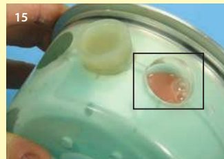
15 Durch ein Hin- und Herschwenken der Küvette treten Lufteinschlüsse aus.
