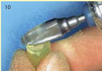
10 Pi-Ku-Plast HP 36 ist wärmeunempfindlich, bleibt beim Beschleifen formstabil und ermöglicht eine Passgenauigkeit, die weit über der Norm liegt.
