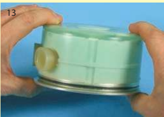
13 Die Küvette wird lagerichtig mit einem Zentrierungs-Snap geschlossen.
