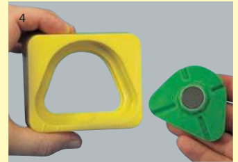
4 Die Master-Pin Hülsen überragen die Master-Pins um ca. 0,5 mm, wodurch immer eine einheitlich konstante Höhe des Zahnkranzes entsteht.
