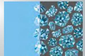
Diamantkristalle in einer speziellen Bindemischung eingebettet.
