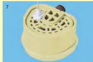
Die Küvettenmanschette wird mit Technosil gefüllt.
