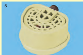
6 El estabilizador para el duplicado se monta encajado en el alojamiento disponible en la cubeta y se ajusta a la altura correspondiente para cada modelo. Esto impide cualquier deformación indeseada del molde de silicona al verter la masilla de revestimiento.
