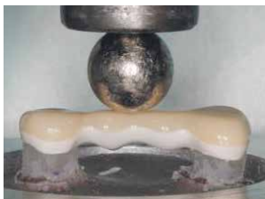
Estructura de prueba con cuerpos de prueba estandarizados de la Universidad de Ratisbona e)
