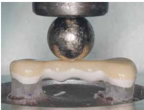
Montaggio di prova con campioni standardizzati dell'Università di Regensburg e)
