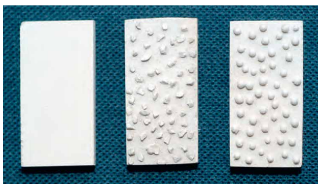
Fig. 7: Provini con superfici in BioHPP preparate con differenti metodiche (a sinistra: fresate, al centro: con cristalli, a destra: con perle). 8)
