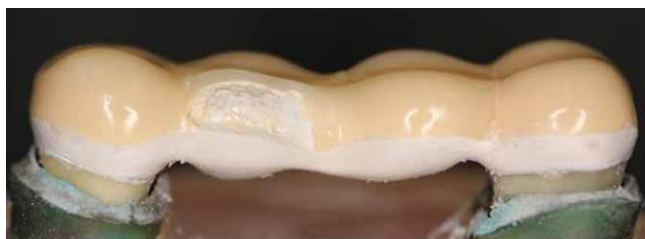
Fig. 39: Ponte dopo test di carico con chipping del rivestimento. 52)
