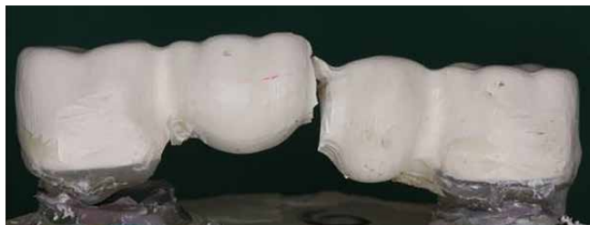
Fig. 33: Frattura di un ponte in BioHPP realizzato con tecnologia CAD/CAM. 43)
