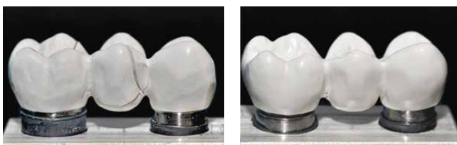
Fig. 23: A sinistra una frattura spontanea di un ponte fresato in breCAM.BioHPP, a destra una deformazione plastica di un ponte realizzato in BioHPP in granuli. 28)
