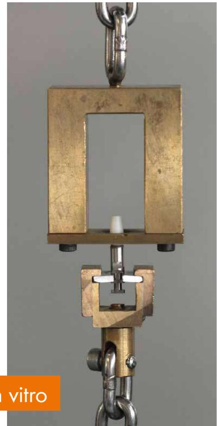
Illustration\* : Montage d'essai - Essai de résistance à la traction (vitesse de la tête cruciforme de 2 mm/min)
