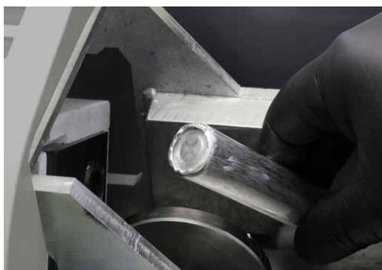
Comprobar tras cerrar el cartucho si cabe dentro del elemento calefactor del equipo thermopress 400 (evitar la inserción en un elemento calefactor que esté caliente para evitar quemaduras).
