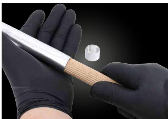
Introducir la varilla de transporte de madera en el cartucho y rodarlos conjuntamente sobre la palma de la mano para corregir la deformación.
