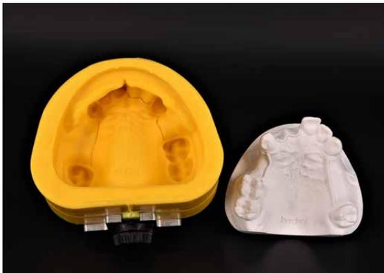
El modelo de Expando-Rock puede extraerse tras su curado inicial. Sin embargo es un error pretender usarlo antes del tiempo completo requerido para su expansión, de 6 horas, pues esto puede acarrear problemas de ajuste.
