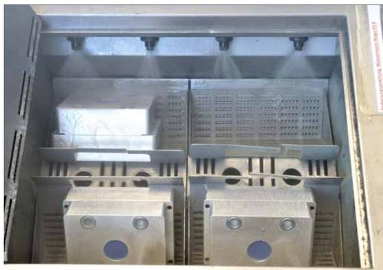
Escaldar de la forma habitual, durante unos 8 minutos. Soltar los tornillos antes de escaldar, pues luego estará todo muy caliente. Si utiliza un equipo de cocción, disponga el orificio de moldeo hacia abajo para que la cera pueda salir. Al escaldar en un recipiente, el orificio de moldeo debe mirar hacia arriba para que la cera pueda salir.
