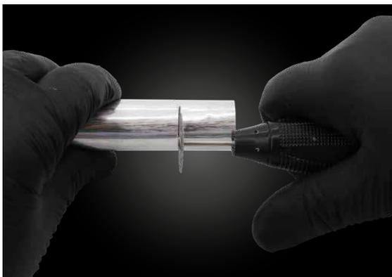
Acortar con cuidado con un disco diamantado Giflex-TR (REF 34000110) sin comprimir el cartucho.
