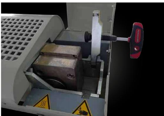
Una vez transcurrido el tiempo de presión de mantenimiento, soltar la palanca de sujeción y plegarla hacia arriba, luego pulsar el botón de expulsión. A continuación, se podrá eliminar los restos del cartucho de la mufia con un martillo y una espátula.
