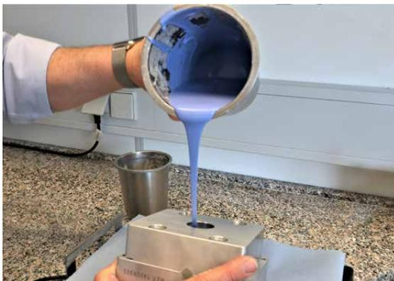
Como puede observarse, la mufla se ha inclinado para llenar primero la parte delantera de la cavidad. Esta técnica también ayuda a reducir el aire atrapado. Así se completa el proceso de llenado de la mufla (el orificio para la inyección del material se encuentra en la parte posterior de la mufla).
