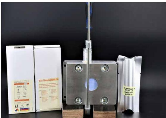
Tras moldear zonas voluminosas, posicionar justo después de moldear usando un gancho. Esto evita la formación de cavidades dentro del equipo de moldeo causada por material que se ha salido del canal de moldeo.
