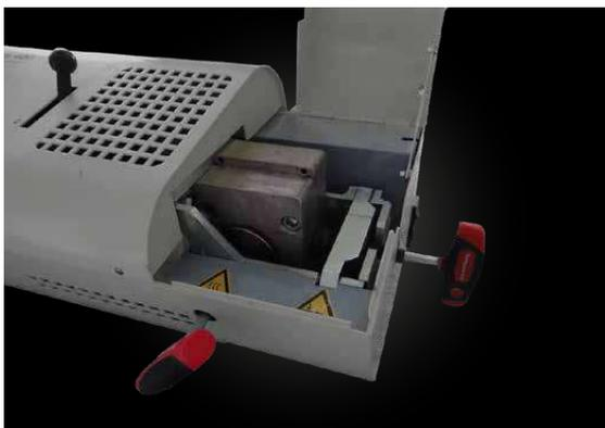
Introducir la mufia en el sentido de la flecha, empujarla sobre el bastidor en dirección a la cámara de calentamiento, cerrar el estribo de sujeción y fijarla ligeramente con el tornillo de bloqueo delantero. A continuación, apretar el tapón de cierre derecho para que quede encajada en el bastidor.
