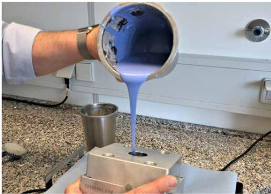
Como puede observarse, la mufla se ha inclinado para llenar primero la parte delantera de la cavidad. Esta técnica también ayuda a reducir el aire atrapado. Así se completa el proceso de la mufla (el orificio para la inyección del material se encuentra en la parte posterior de la mufla).
