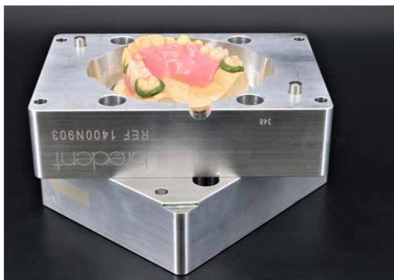
Se comprueba la altura del modelo. Esta comprobación es importante una vez finalizadas las zonas superiores. No hay nada más engorroso que insertar el modelo y comprobar entonces que la parte superior de la mufla está taponada.
