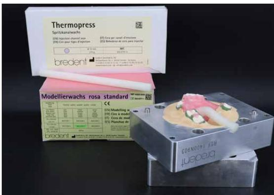
El modelo encerado se ha incorporado usando Exakto-Rock S y un bebedero de 10 mm de diámetro. Tal como ya se ha mencionado, el bebedero se dispone de modo que el material de moldeo entre al centro de la cavidad y se llene ésta uniformemente hasta el canto superior. De este modo se garantiza que la cavidad se llena de forma correcta y uniforme desde el centro de la estructura hacia fuera.
