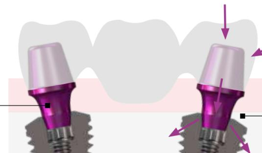
La lunga conicità trasmette le forze laterali e occlusali direttamente all'interno della connessione implantare proteggendo le viti da allentamenti e fratture
