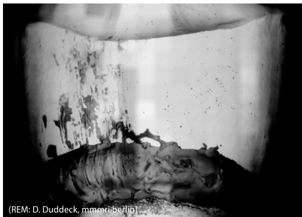
Immagini SEM della zona sottomucosa di un abutment ibrido
